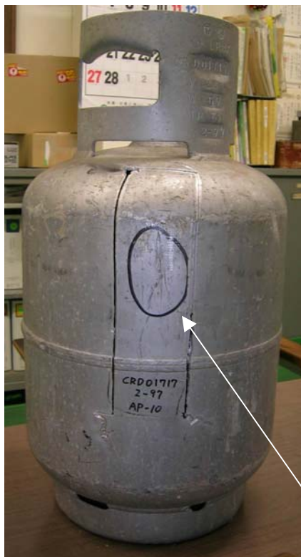
縦方向に発生した亀裂
