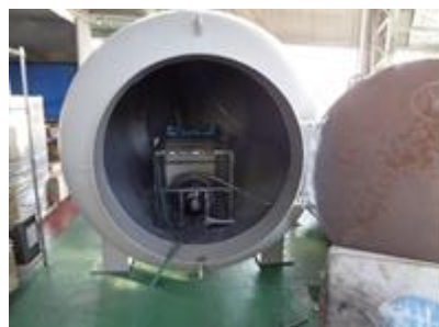
水加圧試験状況
