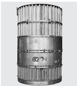
コイル焼鈍炉用インナーカバー （ステンレス製） （直径2.5m×高さ5.0m）
